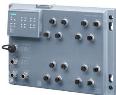
SCALANCE XP216PoE EEC, managed IE Switch, mit Bahn- Zulassung IEC 62443-4-2 zertifiziert; (EN 50155, EN45545); 12x 10/100 Mbit/s M12 Ports, 4x 10/100/1000 Mbit/s M12 Ports IP65, LED-Diagnose, Fehler-Meldekontakt, redundante Spannungsversorgung, PROFINET IO Device, Netzwerk-Management, im redundanten Ring betreibbar, inkl. Staubschutzkappen, inkl. elektron. Handbuch auf CD-ROM, C-PLUG optional.
