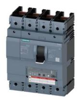
Leistungsschalter 3VA6 UL Frame 400 Schaltvermögenklasse M 35kA @ 480V 4-polig, Anlagenschutz ETU330, LIG, In=250A Überlastschutz Ir=100A...250A Kurzschlussschutz Ii=1,5...12 x In N-Leiterschutz einstellbar (OFF, 50%, 100%) Erdschlussschutz Ig=0,2...1 x In= tg=0,1/0,3s ohne Anschluss
