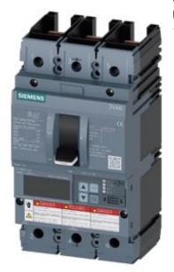
Leistungsschalter 3VA6 UL Frame 150 Schaltvermögenklasse C 100kA @ 480V 3-polig, Anlagenschutz ETU850, LSI, In=40A Überlastschutz Ir=16A...40A Kurzschlussschutz Isd=0,6..10x In, Ii=1,5..12x In N-Leiterschutz optional mit externem Stromwandler, bis 160% ohne Anschluss
