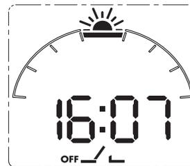
Vom **Anzeige-Modus** ist es möglich, durch zentrales Drücken <2 s auf den Joy-Stick in den **Programmier-Modus** oder durch zentrales Drücken >2 s auf den Joy-Stick in den **Setup-Modus** zu wechseln.
