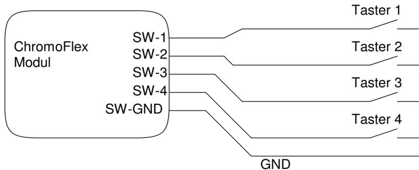
Die Kabellänge der Tasten darf erfahrungsgemäß zu 10 Mtr. betragen. Wir empfehlen bei längeren Kabeln die Verwendung von Kabeln mit Schirm. Dieser sollte auf SW-GND gelegt werden.
