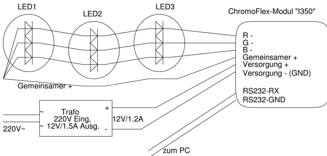
Im obigen Beispiel wurden 3 LEDs verwendet. Mit einem 4-adrigen Kabel lassen sich die LEDs anschließen, wobei eine Ader als Rücklauf benötigt wird.
