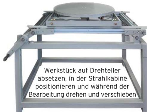
Werkstück auf Drehteller absetzen, in der Strahlkabine positionieren und während der Bearbeitung drehen und verschieben
