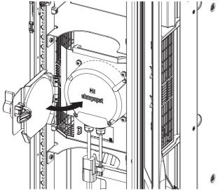
Fig. 54: Closing the fan door
