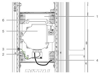
Fig. 47: Fan module in fan tray
