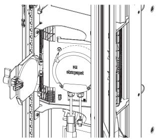
Fig. 53: Pushing in the fan module
