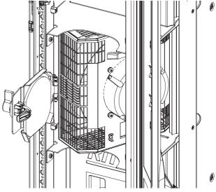
Fig. 48: Rotated fan module in fan tray
