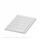
Marker für Klemmen, Matte, weiß, unbeschriftet, beschriftbar mit: TOPMARK NEO, TOPMARK LASER, BLUEMARK ID COLOR, BLUEMARK ID, BLUEMARK CLED, THERMOMARK PRIME, THERMOMARK CARD 2.0, THERMOMARK CARD, Montageart: verrasten, für Klemmenbreite: 6,2 mm, Schriftfeldgröße: 5,6 x 10,5 mm, Anzahl der Einzelschilder: 60
