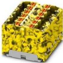
Verteilerblock, die Blöcke sind untereinander über den Leiterschacht brückbar, passende Steckbrücken siehe Zubehör, intern gebrückt, Nennspannung: 450 V, Nennstrom: 17,5 A, Anschlussart: Push-in-Anschluss, Querschnitt: 0,14 mm<sup>2</sup> - 2,5 mm<sup>2</sup>, Montageart: aufrasten auf Tragschienenadapter, Direktmontage mit Flansch, Fliegend, Farbe: schwarz/gelb
