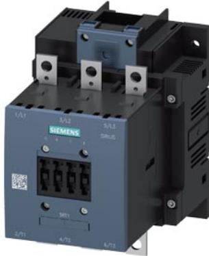
Leistungsschütz, AC-3e/AC-3 150 A, 75 kW / 400 V AC (50-60 Hz) / DC U<sub>c</sub>: 220-240 V 3-polig, ohne Hilfskontakte Antrieb: konventionell Hauptstr.: Schiene Steuer- und Hilfsstromkreis: Schraubanschluss
