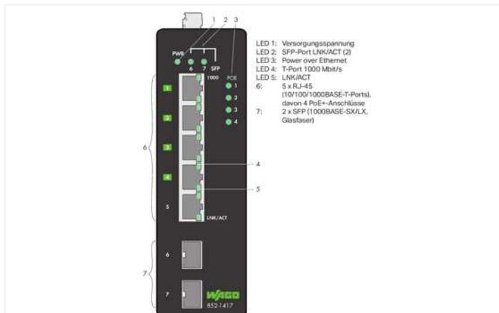
Der Switch 852-1417 ist ein industrieller Unmanaged-ETHERNET-Switch mit 5 Gigabit-ETHERNET-Ports, wovon 4 Ports "Power over Ethernet" (PoE+) mit 30 W unterstützen. Diese 4 PoE+-Ports (IEEE 802.3at) können zeitgleich zur Energieversorgung von PoE-Endgeräten (Powered Devices) eingesetzt werden. Zusätzlich verfügen die Switches über 2 SFP-Slots (1000BASE-Module). Der integrierte Spannungswandler ermöglicht den Betrieb mit der im Schaltschrank üblichen Versorgungsspannung von DC 24 V.
