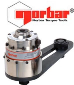
Hochleistungs Kraftvervielfältiger Handtorque HT 5/25 der Standardserie: Das vom Drehmomentschlüssel bereitgestellte Eingangsdrehmoment wird im Verhältnis 25:1 multipliziert. Es können daher viel kleinere Drehmomentschlüssel für eine gegebene Drehmomentanwendung verwendet werden. Das Gewicht von kleinem Drehmomentschlüssel plus Kraftvervielfältiger ist oft geringer als das eines großen Drehmomentschlüssels.
