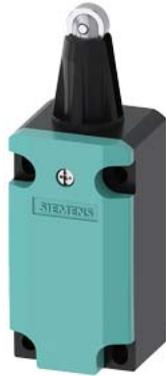
Positionsschalter Metallgehäuse 40 mm nach DIN EN 50041 Rollenstößel mit Edelstahlrolle 13 mm mit 3mm Überhub, 1S/2Ö Sprungkontakte, Geräteanschluss 1x (M20 x 1,5), Betätigungs-/Rückstellkraft 30N nur als Komplettgerät lieferbar
