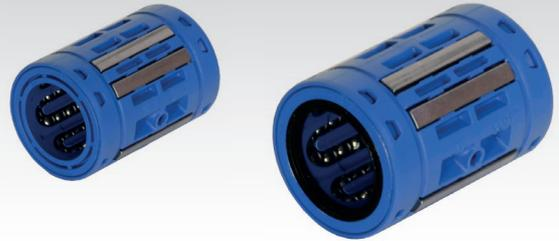
Rostfreie Kugelbuchse in Premium-Qualität. Hohe Tragfähigkeit auf Grund der unsymmetrischen Verteilung der Kugelreihen und der profilierten Laufbahnsegmente. Diese Linearkugellager können sowohl in geschlossenen als auch in geschlitzten Gehäusen eingebaut werden und sind somit einstellbar.
