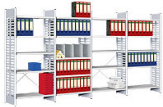
Seitenblechen und sind pulverbeschichtet in Alusilber (ähnlich RAL 9006). Eckfeld auch mit anderen Höhen erhältlich: 2200 mm und 2600 mm. Fachlast: Tragkraft pro Boden: 120 kg, mit Unterzügen bis 200 kg Feldlast (Tragkraft pro Regalfeld): 1000 kg Breite pro Regal = Nennbreite + 40 mm Eckfeld 400 + Tiefe 1 Seitenrahmen 4 Eckböden 1 Eckpfosten
