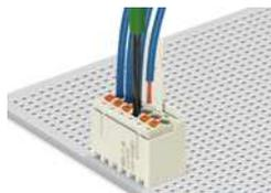
Leiter anschließen – bei gesteckter Federleiste – feindrähtige Leiter mit Drückerbetätigung.
