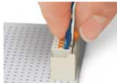
Federleiste mit Griffplatte aus der Stiftleiste herausziehen.
