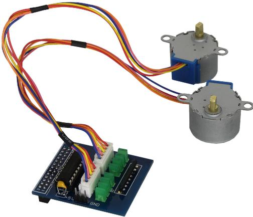
Dieses Set für den Raspberry besteht aus einem Steuerungsboard und 2 Schrittmotoren. Das Board ist fertig assembliert und kann direkt mit dem Raspberry verbunden werden.
