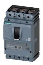
Leistungsschalter 3VA2 IEC Frame 160 Schaltvermögenklasse M lcu=55kA @ 415V 3-polig, Anlagenschutz ETU350, LSI, ln=40A Überlastschutz Ir=16A...40A Kurzschlussschutz Isd=1,5...10 x lr, li=12 x ln Klemmenanschluss
