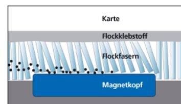
Die hervorragende Schmutzaufnahme des Flocks verhindert das bloße Verteilen des Schmutzes im Innern des Kartenlesers. Die Partikel werden durch die Fasern aufgenommen und mit dem Herausnehmen der Karte entfernt.
