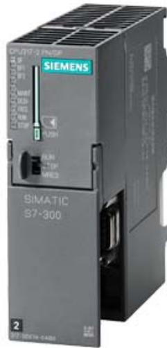
SIMATIC S7-300 CPU 317-2 PN/DP, ZENTRALBAUGRUPPE MIT 1 MB ARBEITSSPEICHER, 1.SCHNITTST. MPI/DP 12MBIT/S, 2.SCHNITTST. ETHERNET PROFINET, MIT 2 PORT SWITCH, MICRO MEMORY CARD ERFORDERLICH
