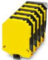
Hochstromklemme, Nennspannung: 1000 V, Nennstrom: 415 A, Anschlussart: Schraubanschluss, Bemessungsquerschnitt: 240 mm<sup>2</sup>, Querschnitt: 70 mm<sup>2</sup> - 240 mm<sup>2</sup>, Montageart: NS 35/15, NS 32, Farbe: schwarz/gelb
