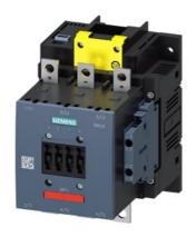
Schütz, AC-1, 275 A/690 V/40 °C, S6, 3-polig, AC/DC 200-277V, F-PLC-IN, mit Varistor, 2S+2Ö, nicht lösbar, Anschlussschiene/ Schraubanschluss
