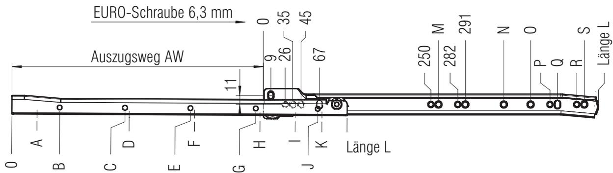
Anschraubbohrungen für 3,5 mm Spax-Schraube / 6,3 mm EURO-Schraube
