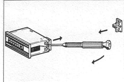
Pour retirer le capot du raccordement universel, il suffit de faire pivoter ou basculer légèrement le tournevis. La vis peut ensuite être retirée de manière à produire un raccordement à enficher.
