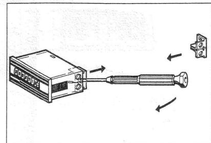
Nell'attacco universale, ruotando o inclinando leggermente il cacciavite, viene rimosso il coperchio. Dopodiché si può estrarre la vite e l'attacco a vite si è trasformato in un attacco AMP.
