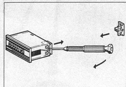
Beim Universalanschluß wird, durch leichtes Drehen oder Kippen des Schraubendrehers, die Abdeckung entfernt. Danach kann die Schraube herausgenommen werden und aus dem Schraubenanschluß ist ein AMP-Anschluß entstanden.
