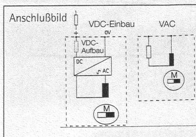
Anschlußklemmen für Drahtdurchmesser 0,8 bis 2,5 mm
