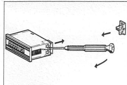
En la conexión universal, la tapa se quita girando o tumbaro ligeramente el destornillador. Luego puede desenroscarse el tornillo, con lo que el empalme roscado se convierte en una conexión AMP.
