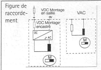
Bornes des raccordement pour fils de 0,8 à 2,5 mm de diamètre.
