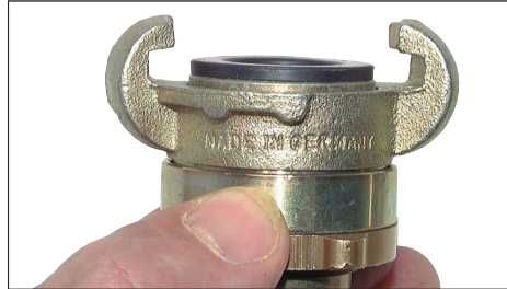
Vorgeschaubte Dichtung - Verbindung ist dicht.
