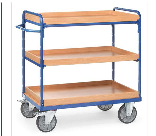
Ensemble mécano-soudé, revêtement époxy bleu RAL 5007. 1 caissette fixe et 2 amovibles en mélaminé surface effet hêtre. Charge maximum par caissette : 120 kg. 2 roues pivotantes et 2 roues fixes à bandage TPE, moyeu à roulement à billes central. Freins sur roues pivotantes conformément à la Norme EN 1757-3 (Sécurité des chariots de manutention).
