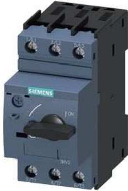
Leistungsschalter Baugröße S0 für den Trafoschutz A-Auslöser 18...25 A N-Auslöser 400 A Schraubanschluss Standardschaltvermögen
