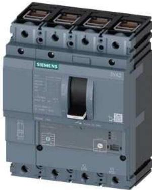
Leistungsschalter 3VA2 IEC Frame 160 Schaltvermögenklasse C Icu=110kA @ 415V 4-polig, Anlagenschutz ETU340, ELISA LI, In=63A Überlastschutz Ir=25A...63A Kurzschlusschutz Ii=15 x In N-Leiterschutz einstellbar (OFF, 100%) Klemmenanschluss
