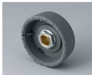
B8133638 STAR-KNOBS 33, mit Noppen PA 6 vulkan 33x14mm 1/4"
