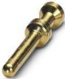
Gedrehter 2,5er Crimpkontakt, Stift-Einzelkontakt, Aderquerschnitt 1,5 mm<sup>2</sup>, vergoldet
