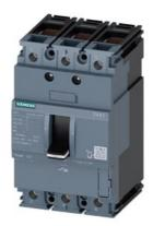
Leistungsschalter 3VA1 IEC Frame 100 Schaltvermögenklasse S Icu=36kA @ 415V 3-polig, Anlagenschutz TM210, FTFM, In=80A Überlastschutz Ir=80A fest eingestellt Kurzschlussschutz Ii=10 x In Klemmenanschluss
