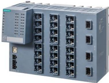
SCALANCE XC324-4EEC managed Layer 2 IE Switch, 24x 10/100/1000 Mbit/s RJ45, 4x 1/10 Gbit/s SFP+ Port, LED- Diagnose, Fehlermeldekontakt mit Select/Set-Taster, PROFINET IO Device, Netzwerk- Management, Redundanzfunktionen, Office Features (RSTP, VLAN, IGMP,...) CLP im Lieferumfang Montage: Hut-/S7-Profileschiene .
