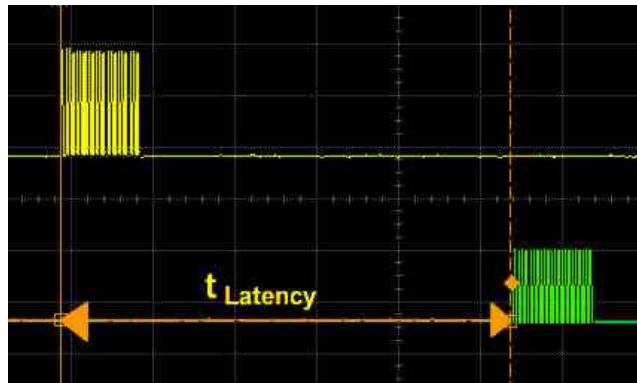
Bild: oben = RX-Line des Senders; unten = TX-Line des Empfängers
