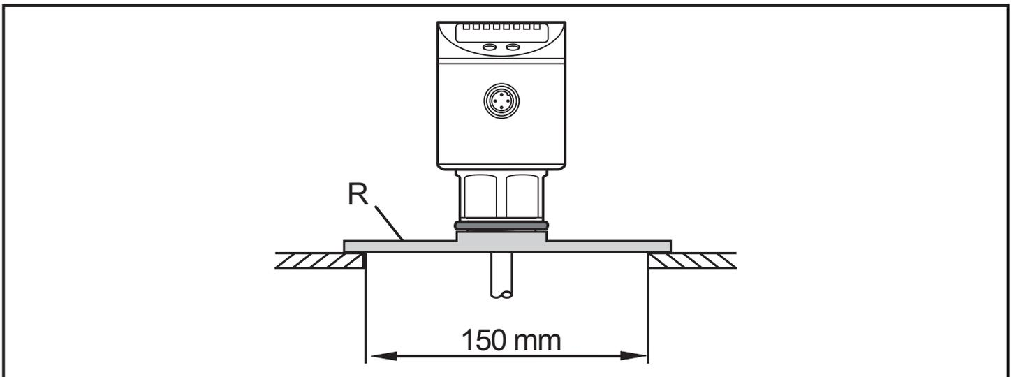
Um eine ausreichende Einkopplung des Messsignals zu ermöglichen, bei Einbau in Kunststoffbehälter oder Metallbehälter mit Kunststoffdecke beachten:
