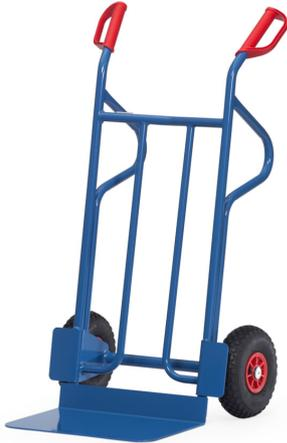
Handlich, mit Stahlblechschaufel, stabile Schweißkonstruktion, pulverbeschichtet, blau, RAL 5007. Sicherheitsgriffe. Stahlblechschaufel anschraubbar und dadurch austauschbar. Räder wahlweise mit Vollgummi- oder Luftbereifung, auf Kunststoff-Felgen, Naben mit Rollenlagerung. Zerlegte Anlieferung.
