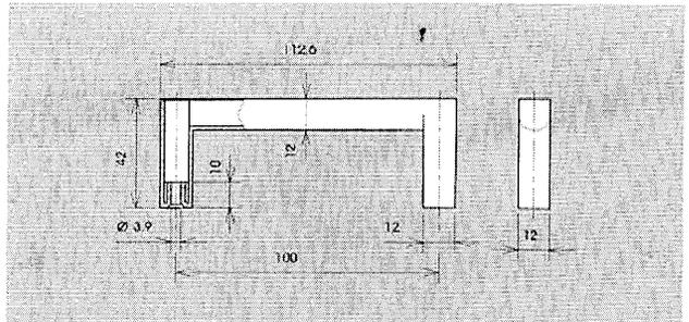
Einschließlich Schrauben DIN 84-M3,5 x 20, Scheiben DIN 125 und Muttern DIN 934-M3,5.
