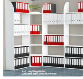
mm tief) Fachlast (Tragkraft pro Boden): 60 kg Feldlast (Tragkraft pro Regalfeld): 350 kg Gesamtbreite: Nennma sse + 20 mm je WangeRegalfeld1000 oder 800 mm breit (1 Seitenwange + 7 Fachböden)Sicherheitshinweis: Regale mit einem Höhen-/Tiefenverhältnis a'¢â€°-¥ 5 : 1 sind gegen Kippen zu sichern (Wand- oder Bodenverankerung).
