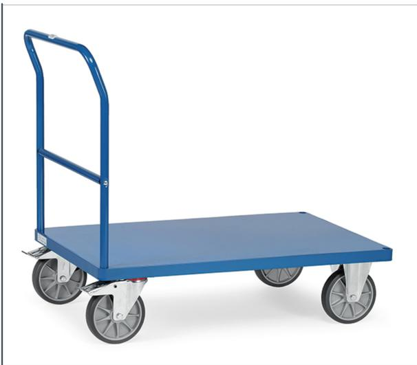
Stahlrohr und Profilstahl geschweißt, pulverbeschichtet RAL 5007, Plattform aus Stahlblech bündig mit Rahmen, sauber eingeschweißt, ebenfalls pulverbeschichtet RAL 5007. 2 Lenk- und 2 Bockrollen, TPE-Bereifung, Naben mit Rillenkugellager. Feststeller an den Lenkrollen, gemäß der Europäischen Norm EN 1757-3 (Sicherheit von Plattformwagen).
