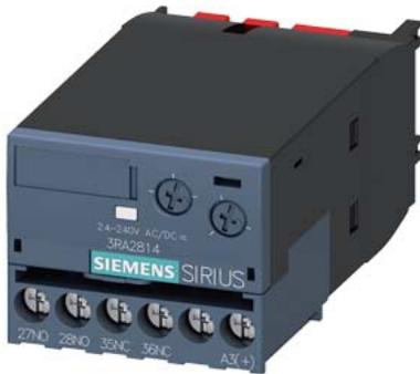
Elektronisch zeitverzögerter Hilfsschalter, rückfallverzögert, mit Steuersignal, Relais 1 Ö + 1 S, Zeitbereich 0,05-100 s, AC/DC 24-240 V, 50/60 Hz, Varistor zur Bedämpfung der Schützspulen integriert, Schraubanschluss, frontseitig aufschraubbar auf Schütze 3RT2 und Hilfsschütze 3RH2
