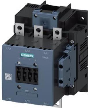
Leistungsschütz AC-1 275 A / 690 V / 40°C 3-polig, Uc: 23-26 V AC(50-60 Hz) / DC Antrieb: konventionell Hilfskontakte 2 S + 2 Ö Hauptstr.: Schiene Steuer- und Hilfsstromkreis: Schraubanschluss
