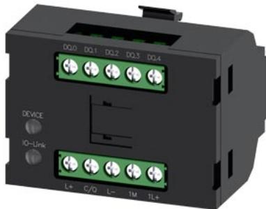
Elektronikmodul IO-Link für ID-Schlüsselschalter, mit 5 vorprogrammierten elektronischen Schaltern, Controller und RFID Authentifizierung der Schaltfunktion, schwarz, Betriebsspannung DC 24 V, Schraubanschluss, für Frontplattenbefestigung, für industrielle Anwendung in Schaltschränken und Maschinen
