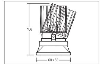
LED-System-Einbaustrahler COUPLED, vertieft, dim2warm, weiß. Ausgeführt in kompakter Bauform für werkzeuglose Schnellmontage zum Deckeneinbau. Wird die Leuchte gedimmt, verringert sich die Farbtemperatur.
