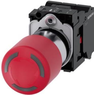
NOT-HALT-Pilzdrucktaster, beleuchtbar, 22 mm, rund, Metall, hochglanz, rot, 30 mm, zwangsläufige Verrastung, gemäß DIN EN ISO 13850, Drehentriegelung, Unterlegscheibe für NOT-HALT, gelb, ohne Beschriftung, mit Halter, 1Ö, 1Ö, LED-Modul 24V rot, Federzuganschluss, Frontplattenbefestigung
