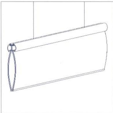
Die Deckenbefestigung erfolgt wahlweise mittels herkömmlichen Haken oder der Deckenautomatik.
