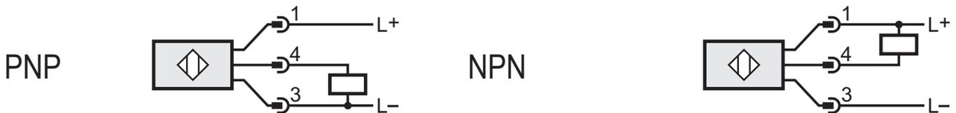
Beim Einschalten erkennt das Gerät automatisch, ob der Ausgang gegen L- (= PNP) oder gegen L+ (= NPN) angeschlossen ist.
