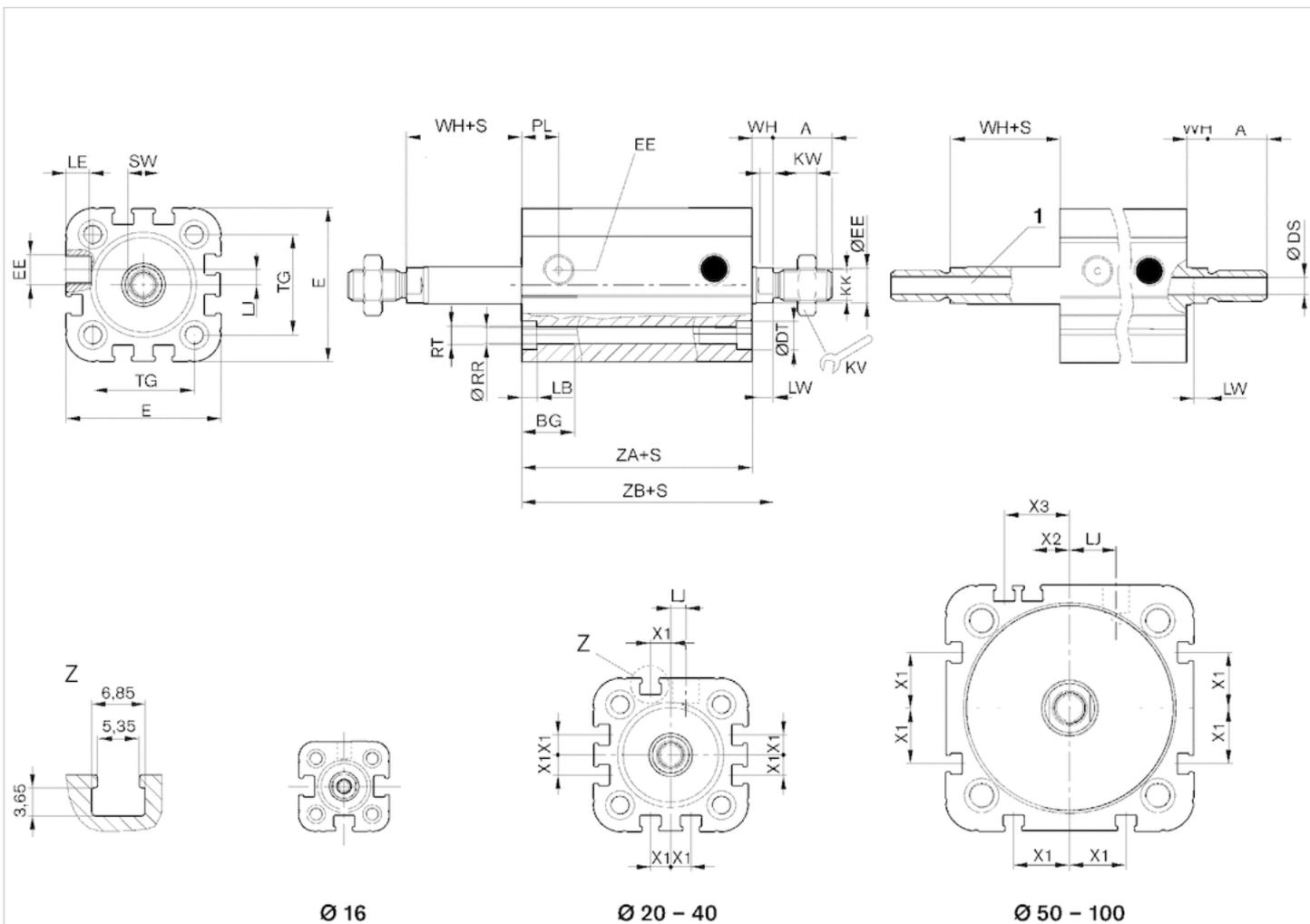
1) Hohle Kolbenstange (im Internetkonfigurator generieren)S = Hub
