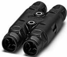
H-Verteiler, QUICKON-Anschluss, Polzahl: 2+PE, 0,5 mm<sup>2</sup> ... 1,5 mm<sup>2</sup>, 690 V, 17,5 A, schwarz, ohne QUICKON-Mutter
