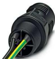
Wanddurchführung, QUICKON-Anschluss, Polzahl: 2+PE, 0,5 mm<sup>2</sup> ... 1,5 mm<sup>2</sup>, 690 V, 17,5 A, schwarz, ohne QUICKON-Mutter, Montagegewinde: M20, Einzeladern, 1,5 mm<sup>2</sup>, Leitungslänge: 1 m
