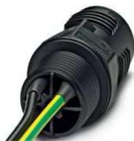
Wanddurchführung, QUICKON-Anschluss, Polzahl: 2+PE, 0,5 mm<sup>2</sup> ... 1,5 mm<sup>2</sup>, 690 V, 17,5 A, schwarz, ohne QUICKON-Mutter, Montagegewinde: M20, Einzeladern (angeschweißt), 1,5 mm<sup>2</sup>, Adern glatt abgeschnitten, Leitungslänge: 0,5 m
