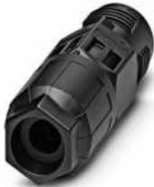
Leitungsverbinder, QUICKON-Anschluss, Polzahl: 2+PE, 0,5 mm<sup>2</sup> ... 1,5 mm<sup>2</sup>, 690 V, 17,5 A, schwarz, mit einer QUICKON-Mutter, Leitungsaußendurchmesser : 5 mm ... 9,5 mm, QUICKON-Schnellanschluss
