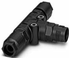
T-Verteiler, QUICKON-Anschluss, Polzahl: 2+PE, 0,5 mm<sup>2</sup> ... 1,5 mm<sup>2</sup>, 690 V, 17,5 A, schwarz, mit zwei QUICKON-Muttern, Leitungsaußendurchmesser: 5 mm ... 9,5 mm
