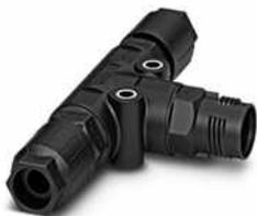
T-Verteiler, QUICKON-Anschluss, Polzahl: 2+PE, 0,5 mm<sup>2</sup> ... 1,5 mm<sup>2</sup>, 690 V, 17,5 A, schwarz, mit zwei QUICKON-Muttern, Leitungsaußendurchmesser: 10 mm ... 13 mm
