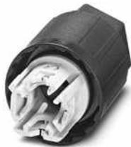
Mutter, QUICKON-Anschluss, Polzahl: 2+PE, 0,5 mm<sup>2</sup> ... 1,5 mm<sup>2</sup>, 690 V, 17,5 A, schwarz, Leitungsaußendurchmesser: 5 mm ... 9,5 mm
