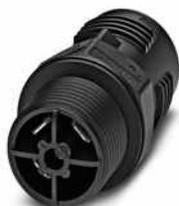
Wanddurchführung, QUICKON-Anschluss, Polzahl: 2+PE, 0,5 mm<sup>2</sup> ... 1,5 mm<sup>2</sup>, 690 V, 15 A, schwarz, ohne QUICKON-Mutter, Montagegewinde: M20, Flachsteckanschluss (für Flachsteckhülsen nach DIN 46247-2), 1,5 mm<sup>2</sup>
