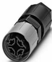
Steckverbinder, QUICKON-Anschluss, Polzahl: 2+PE, 0,5 mm<sup>2</sup> ... 1,5 mm<sup>2</sup>, 690 V, 17,5 A, schwarz, mit QUICKON-Mutter, Leitungsaußendurchmesser: 10 mm .. . 13 mm
