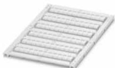
Marker für Klemmen, Matte, weiß, unbeschriftet, beschriftbar mit: TOPMARK NEO, TOPMARK LASER, BLUEMARK ID COLOR, BLUEMARK ID, BLUEMARK CLED, THERMOMARK PRIME, THERMOMARK CARD 2.0, THERMOMARK CARD, Montageart: verrasten, für Klemmenbreite: 5,2 mm, Schriftfeldgröße: 4,4 x 4,7 mm, Anzahl der Einzelschilder: 72
