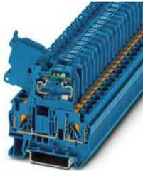
Sicherungsreihenklemme, Art der Sicherung: Glas / Keramik / ..., Sicherungstyp: G / 5 x 20, Nennspannung: 24 V, Nennstrom: 6,3 A, Anschlussart: Push-in-Anschluss, Bemessungsquerschnitt: 1 mm<sup>2</sup>, Querschnitt: 0,2 mm<sup>2</sup>- 6 mm<sup>2</sup>, Montageart: NS 35/7,5, NS 35/15, Farbe: blau
