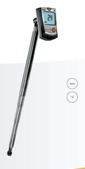
testo 405 ist ein thermisches Anemometer. Es ermöglicht die präzise Messung von Luftströmung, Volumenstrom und Temperatur. Mit dem ausziehbaren Teleskop (bis 300 mm) eignet sich das Messgerät insbesondere zur Strömungsmessung im Kanal. Das Teleskop kann dank der mitgelieferten Halterung im Kanal optimal positioniert werden.
