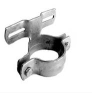
**Rohrschelle aus verzinktem Stahl für Flach-VZ, Pfosten Ø 42-108 mm, Lochabstand 70-900 mm**
